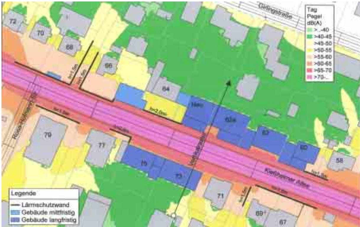
Schallimmissionskarte langfristiges Lösungsszenario, 1,50 m Höhe
