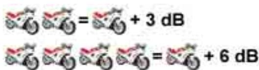
Addition von Schalldruckpegeln (aus [Laut]schrift Schallschutz, S.9)
